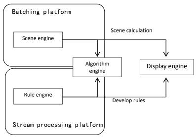
FIGURE 1 RECOMMENDED BASIC FRAMEWORK FOR THE SYSTEM
